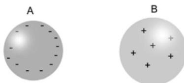
Figura 3 – Corpo A carregado negativamente e corpo B depois de retirado do fio de aterramento.
