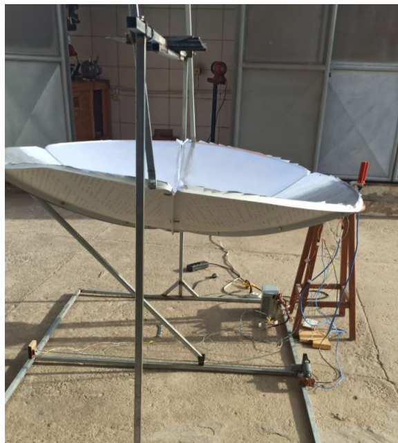
Figura 26 – Parabólica revestida com vinil adesivo metalizado.
