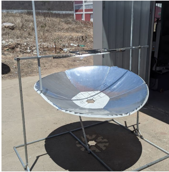
Figura 15 – Montagem da parabólica.
