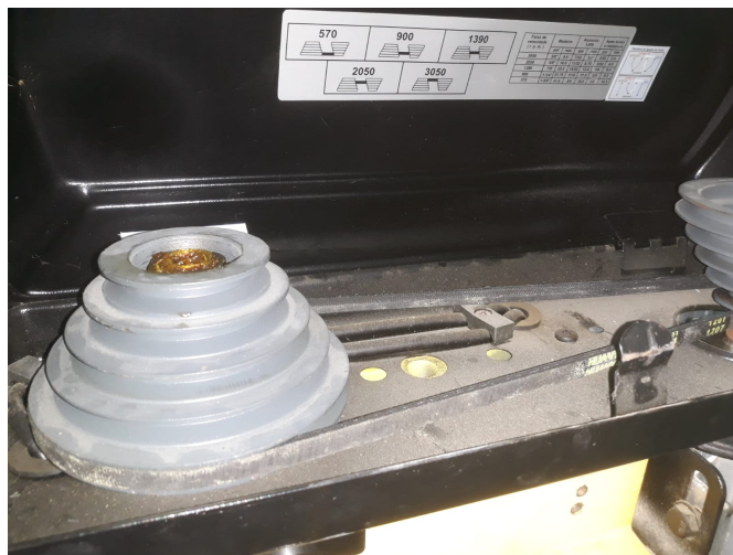
Figura 16 – Sistema de polias e correias da FU01.
