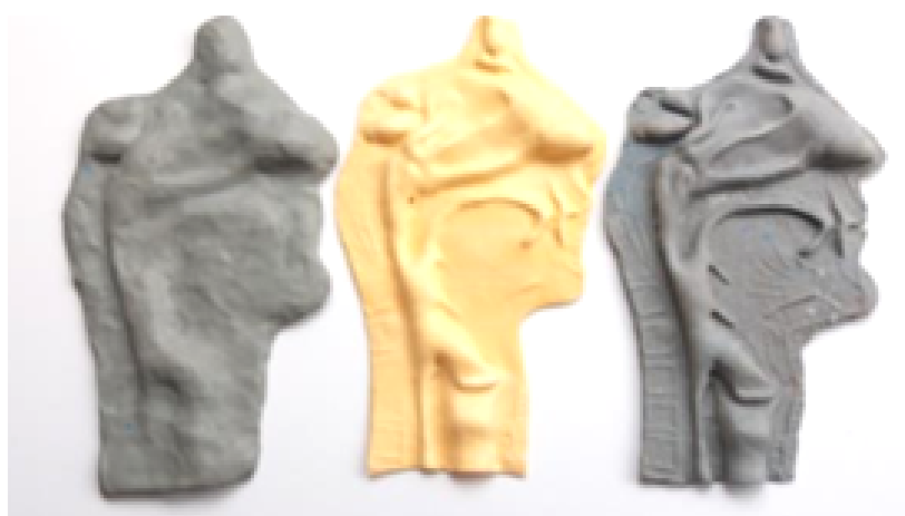
Fig. 1. Protótipo em resina Epóxi (extremidades) e EVA (centro)
