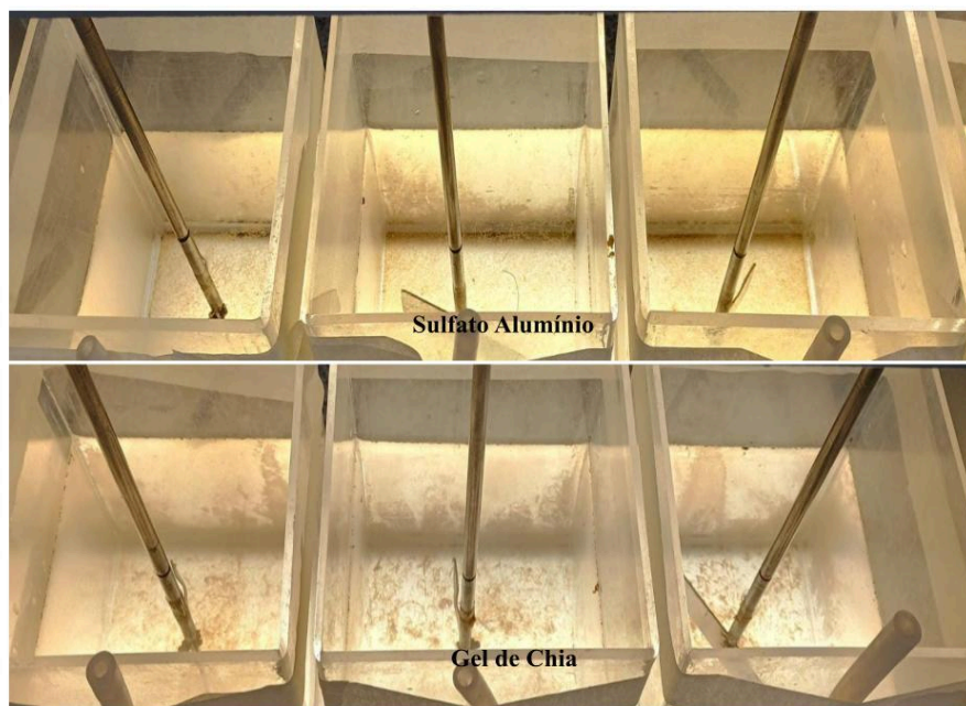
Figura 13 - Diferença dos tamanhos dos Flocos formados pelo coagulante sintético (Sulfato de Alumínio) e pelo coagulante orgânico (Gel da Chia )
