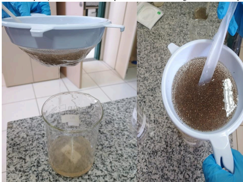
Figura 10 - Separação das fase Sólida/líquida das sementes do gel com o uso de peneira
