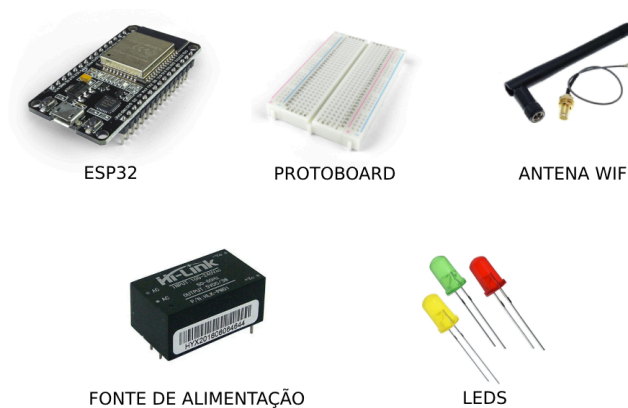
Figura 4. Componentes utilizados nos nós da rede.
