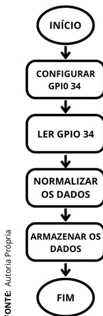
**Figura 3.5** – Etapas do processo de integração do módulo LDR.
