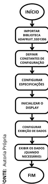
Figura 3.15 – Etapas do processo de integração do display OLED.
