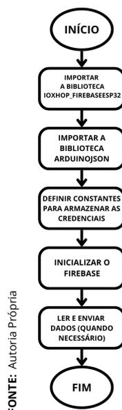
**Figura 3.19** – Etapas do processo de configuração do Firebase.
