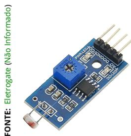
**Figura 3.4** – Módulo Sensor LDR.
