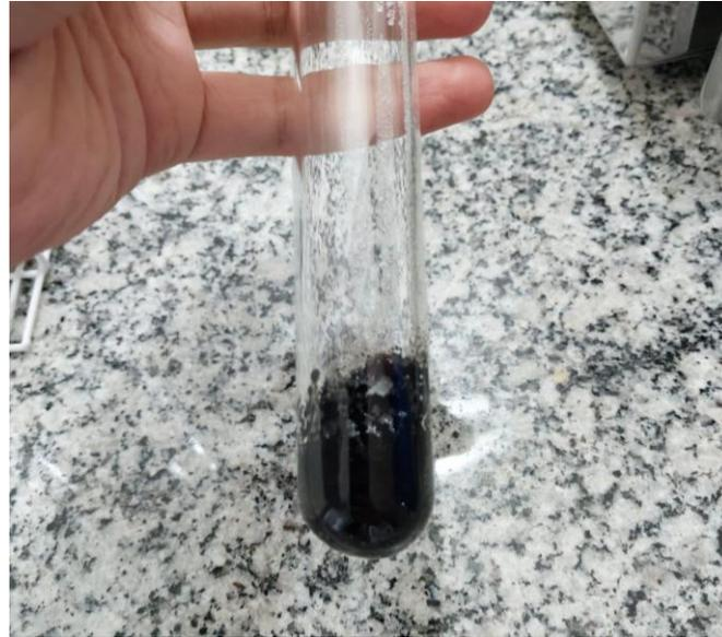
Por fim, os tubos, após pré-digestão durante a noite, foram levados ao bloco digestor modelo SL – 25/40, para finalizar a etapa de digestão, como mostrado o resultado após esse processo na figura 8.
