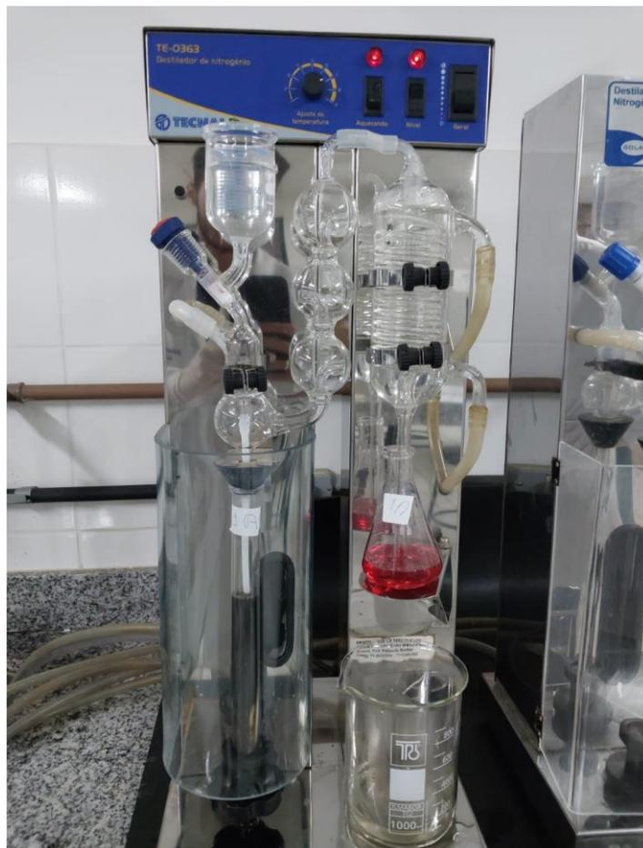
Ao longo do processo foi ocorrendo o escurecimento (evidenciando que a amônia está sendo capturada pela solução contendo ácido bórico no erlenmeyer) como observado na figura 10.
