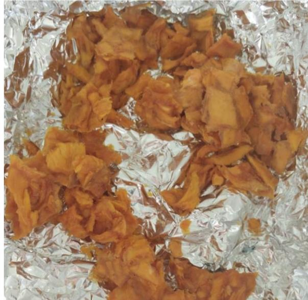
Após secagem, as amostras foram trituradas em moinho de facas tipo willye de marca Fortinox e modelo star ft 50. Posteriormente, as amostras foram conservadas em refrigerador para evitar contaminação por fungos ou outros microrganismos. A figura 5 apresenta a amostra após processo de secagem e moagem.
