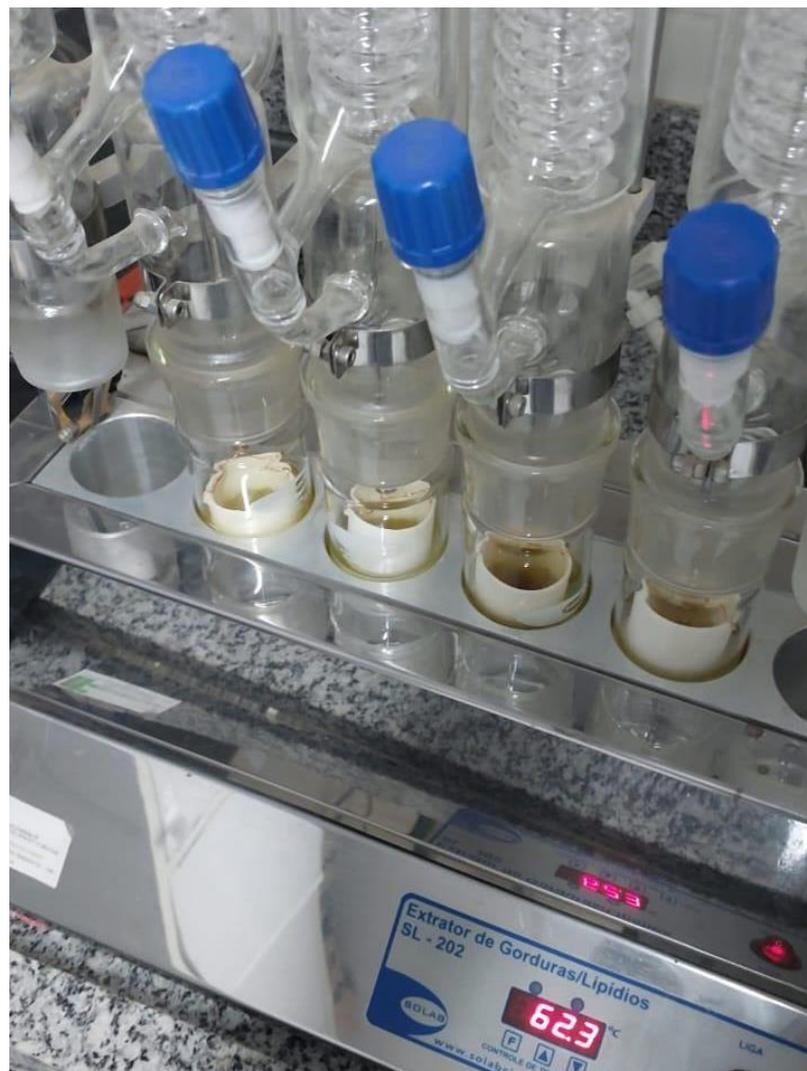
Antes disso os cartuchos extratores que foram colocados suspensos nos copos extratores foram previamente pesados e suas massas foram registradas, estes copos que continham três esferas de vidro cada. O solvente utilizado no processo foi o éter de petróleo que extraiu a gordura através de sua vaporização em refluxo.
