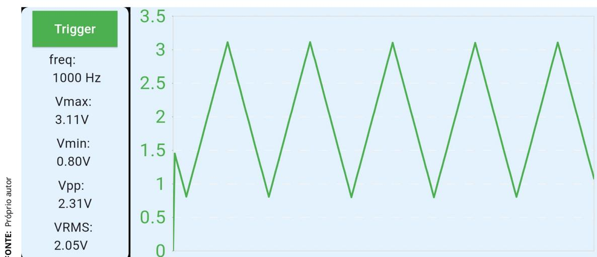
**Figura 4.26** – Erro da posição inicial em 0 no gráfico e logo em seguida retorna para o valor da amostra.
