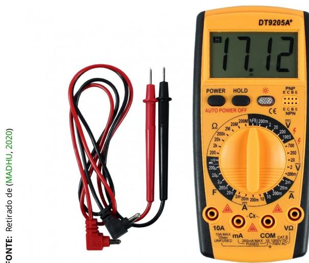
Figura 3.13 – Multímetro com funções de ohmímetro e capacitímetro.
