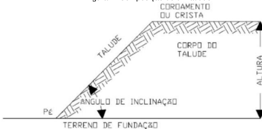
Figura 1- Composição de um talude
