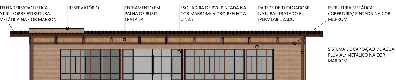
FACHADA FRONTAL PAVILHÃO ITAJI
