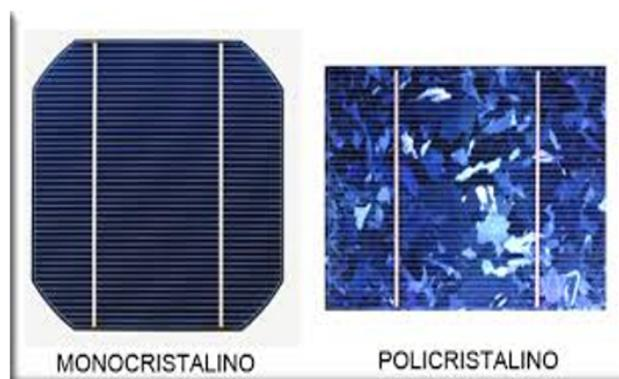
**Figura 14** - Modelo de células fotovoltaicas.
