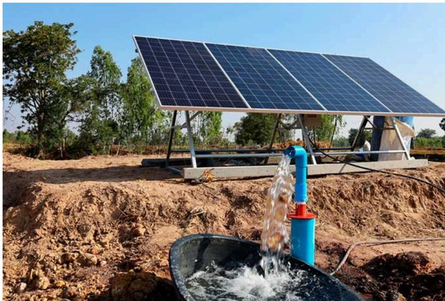
**Figura 15** - Exemplo de um sistema de bombeamento solar.
