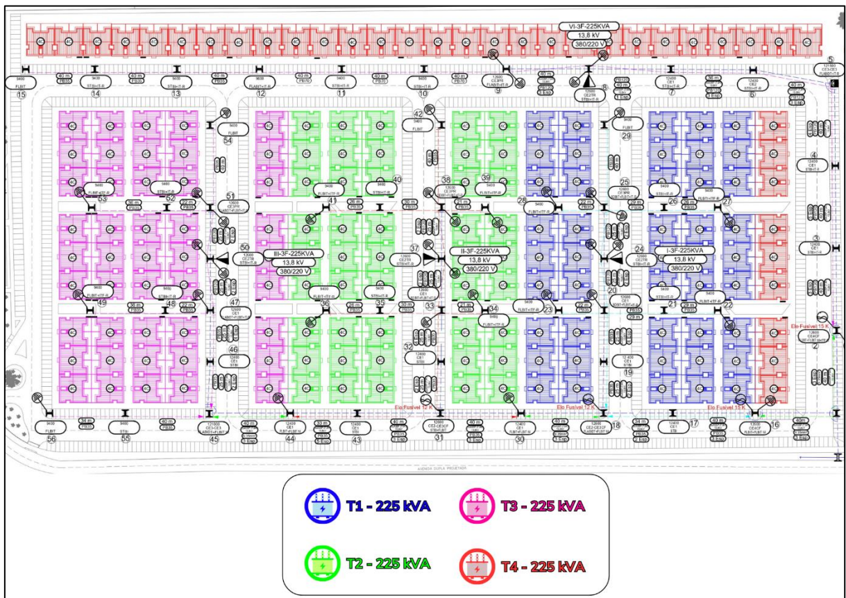
Figura 4.23 – Distribuição dos transformadores para o Projeto D.
