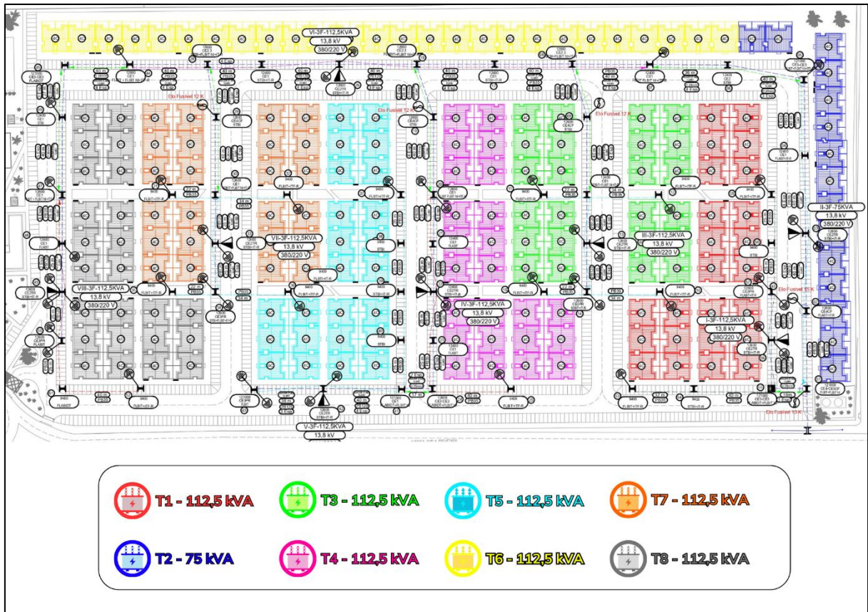
Figura 4.17 – Distribuição dos transformadores para o Projeto A
