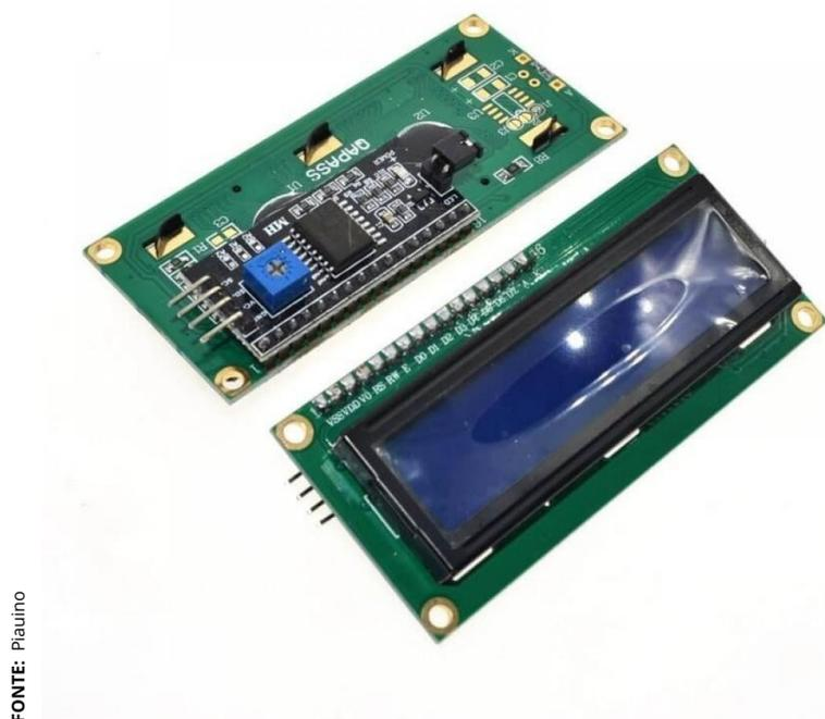
Figura 3.3 – Módulo LCD 16x2 I2C.
