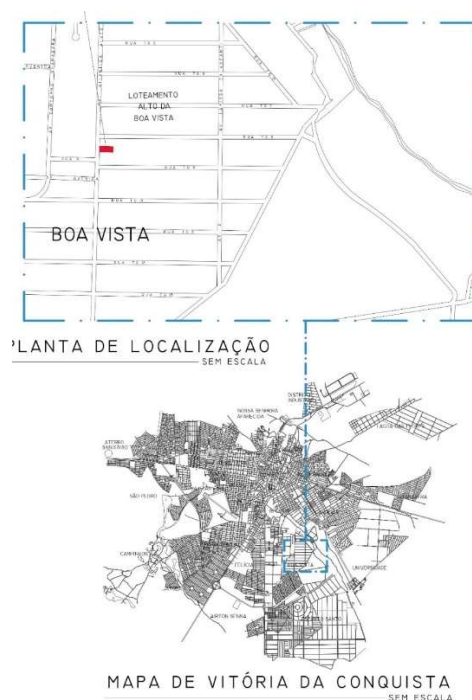
Figura 5 – Exemplo de Planta de Situação
