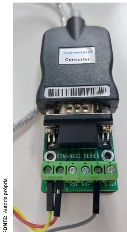
**Figura 4.3** – Ligações do conversor Serial para USB
