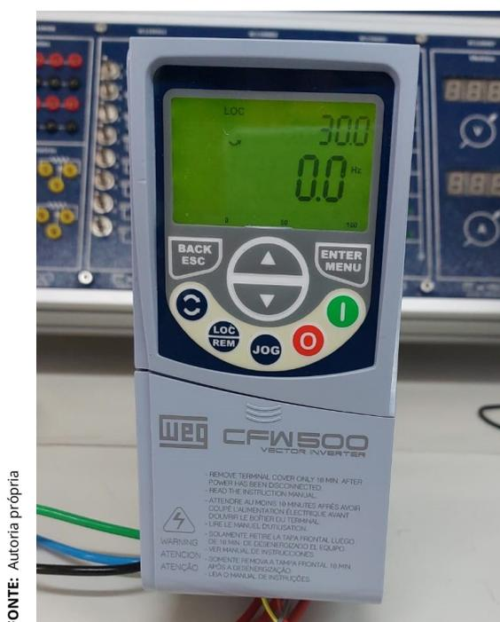
**Figura 4.15** – CFW500 com velocidade armazenada
