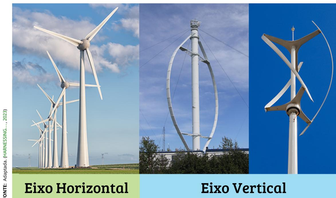
**Figura 2.4** – Turbinas eólicas de eixo horizontal e eixo vertical
