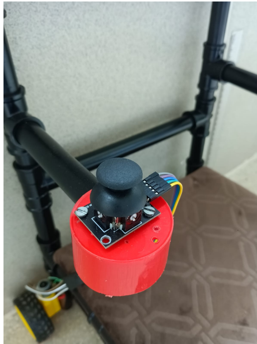
Figura 17 - Implementação do joystick no protótipo.
