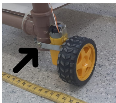
Figura 12 - Fixação dos motores com abraçadeira.
