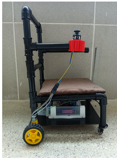
Figura 19 - Protótipo da cadeira de rodas (vista lateral).
