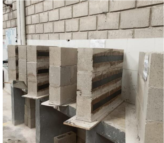
Figura 07 - Prismas com e sem aplicação de fibra
