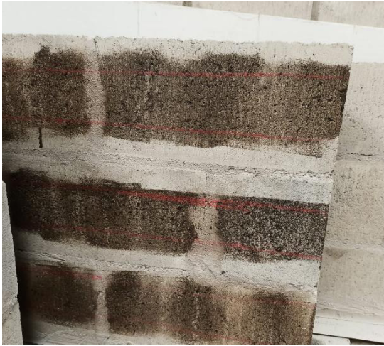
Figura 06 - Prisma com primer aplicado
