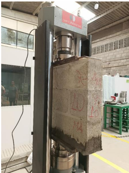
Figura 08 - Prisma sem fibra em rompimento
