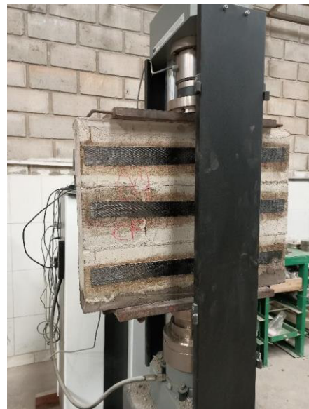
Figura 09 - Prisma com fibra em rompimento
