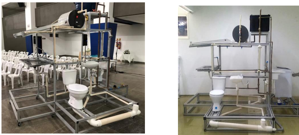
Figura 03: Bancada didática de instalações hidrossanitárias da ALGETEC
