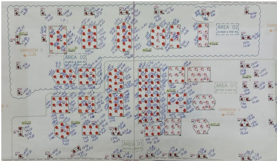
Figura 10 - Gerenciamento das estacas executadas em hélice contínua monitorada na obra Biosphere Essence.
