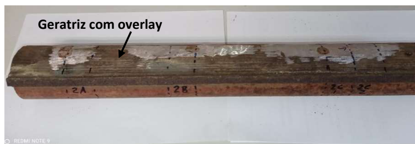
Figura 4.5- Detalhe da marcação e identificação para corte das regiões com recomposição por weld overlay .
