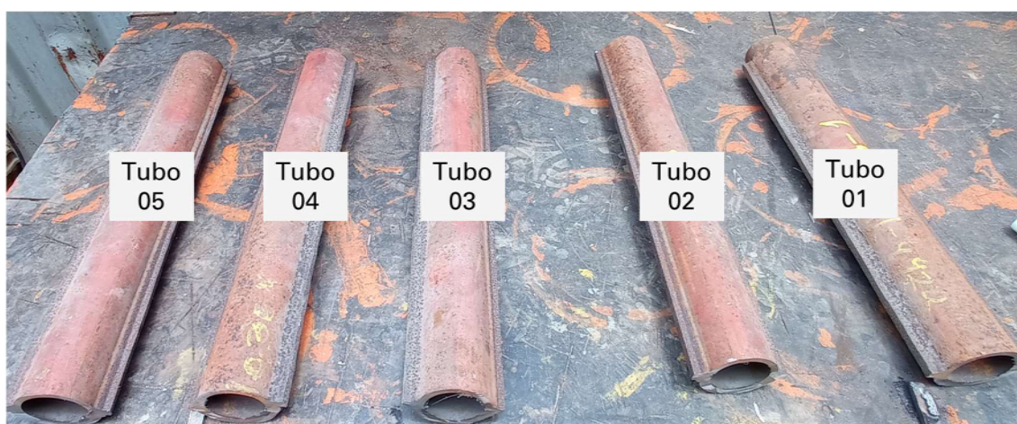
Figura 3.2 - Identificação dos tubos novos, vista da geratriz não revestida. Fonte: Própria
