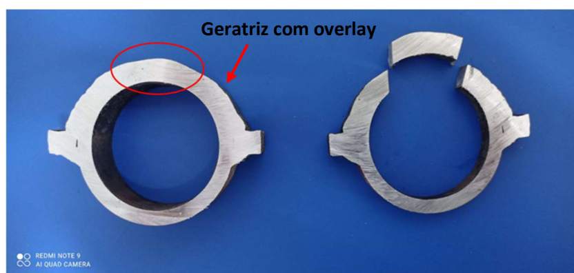
Figura 4.7- Vista do trecho em que foram realizados os reparos, indicando a região a ser analisada e amostra cortada para embutimento.
