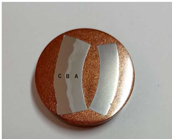
Figura 4.8- Macrografia contendo a região do metal base (A), zona de fusão (B) e revestimento overlay (C). Ataque Nital 3%. Corte transversal.
