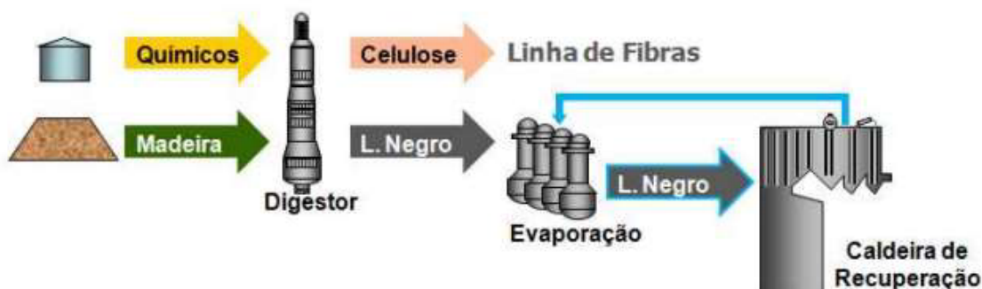
Figura 2.2- Diagrama esquemático simplificado da polpação kraft . Fonte: GUIMARÃES, 2013.
