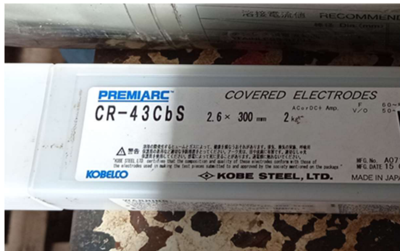
A3- Detalhe do eletrodo utilizado para a realização dos reparos no overlay em campo.
