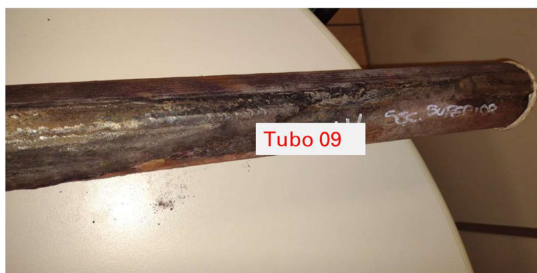
Figura 4.4- Imagem do tubo 09, região que foi utilizada para remoção da amostra de referência, para o tubo usado sem reparo de campo.
