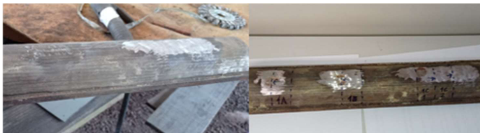
A6- Detalhe de trecho com recomposição do revestimento e posterior identificação para corte das amostras. Fonte: Própria.
