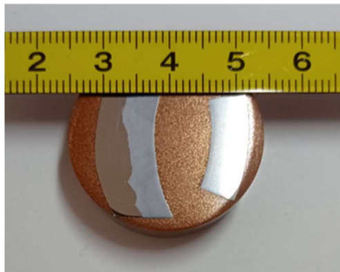
Figura 4.13- Macrografia amostra 5B. Ataque Nital 3%. Corte transversal.
