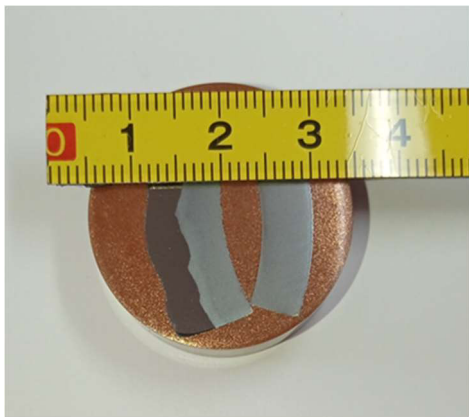
Figura 4.10- Macrografia amostra 2A; Ataque Nital 3%. Corte transversal.
