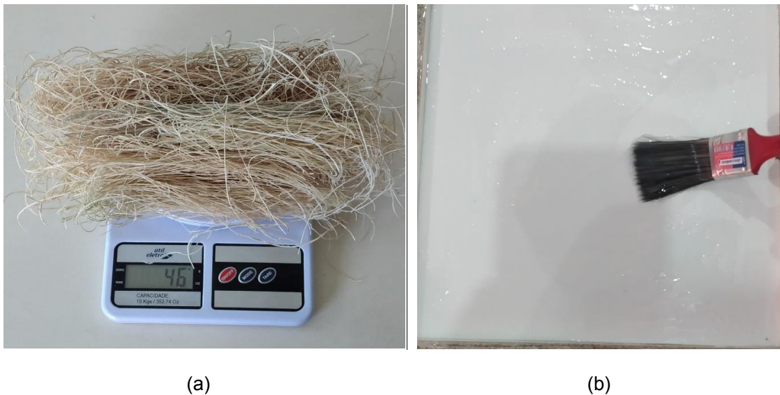
Figura 29: (a) Massa de fibras sendo pesada. (b) Aplicação do desmoldante.
