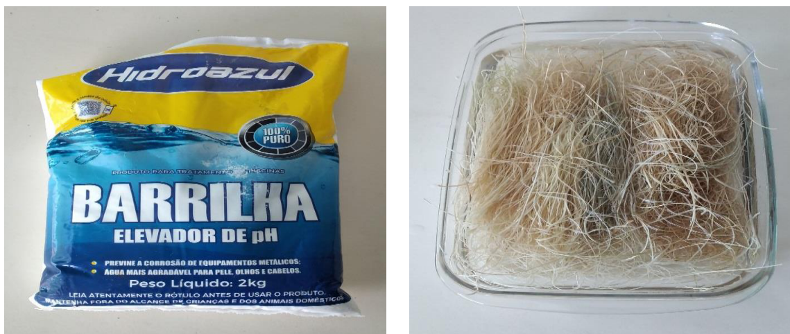
Figura 17: Tratamento alcalino das fibras com barrilha.
