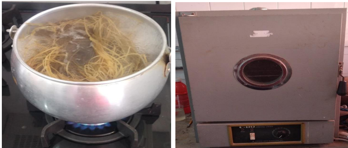
Figura 18: (a) Limpeza das fibras com água fervente. (b) Secagem na estufa.
