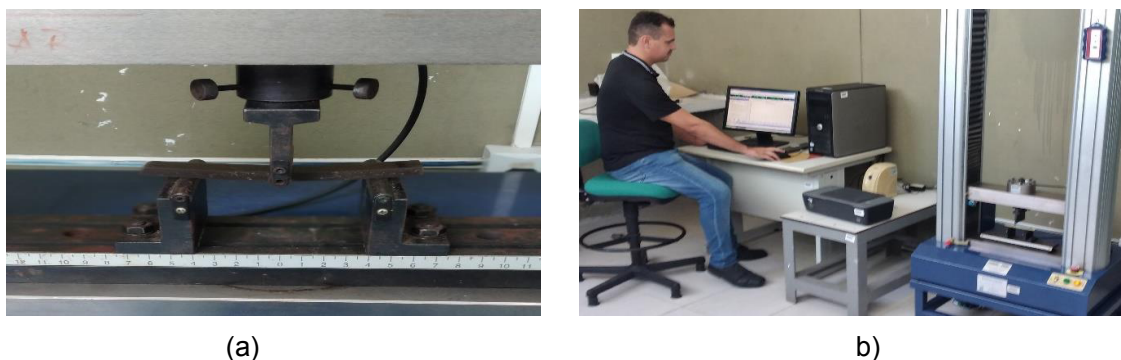
Figura 35: (a) Ensaio de Flexão do CP. (b) Máquina com software de ensaio.
