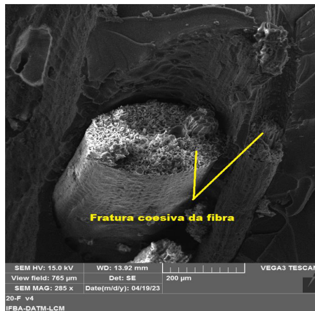
Figura 72: MEV (285x) da região de fratura do ensaio de flexão para o compósito CP20.
