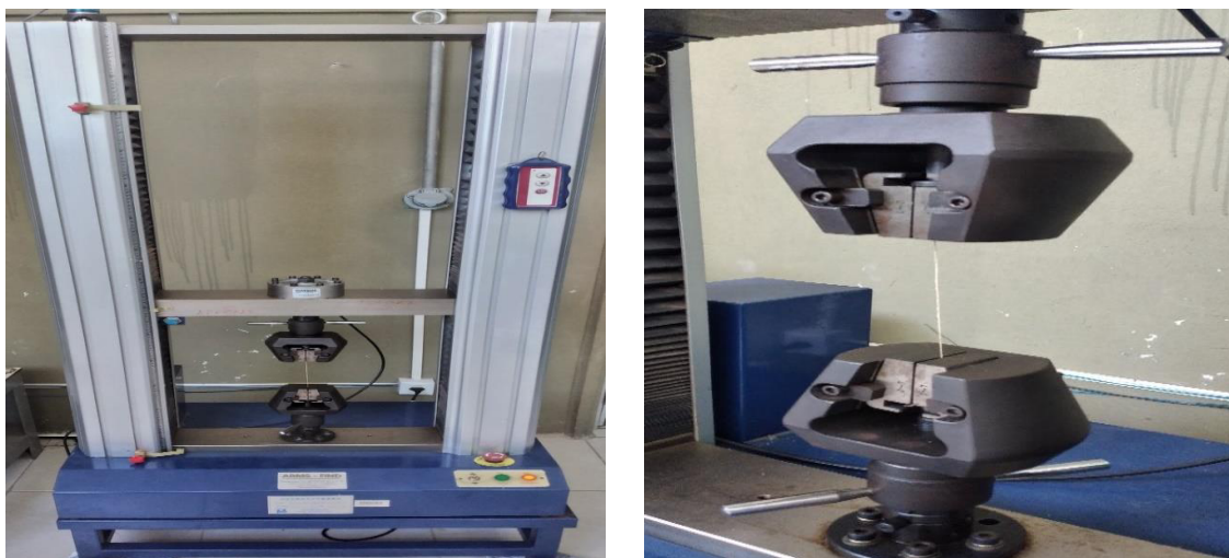
Figura 20: Tração da fibra na máquina de ensaio.
