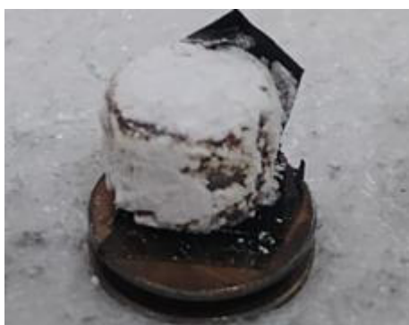
Figura 48: Amostra 91Ti6Si3B do sistema titânio-silício-boro (TiSiB) recoberta com hidroxiapatita-ossos.
