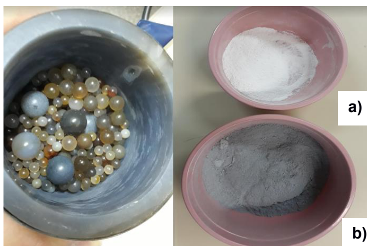
Figura 19: Pós calcinados a 900°C: a) pó de hidroxiapatita-ossos calcinado por 4h e moído por 50min; b) pó de hidroxiapatita-escamas calcinado 1h e moído por 10min.
