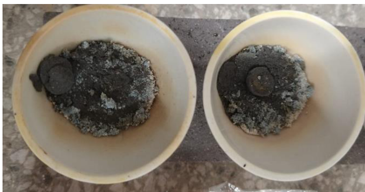
Figura 52: Amostras do sistema titânio-nióbio (TiNb) compactadas a 40kN, sinterizadas 1200°C por 10min com atmosfera de argônio a 8L/min e proteção com pó de dióxido de titânio ( \text{TiO}_2 ) e hidroxiapatita-ossos.
