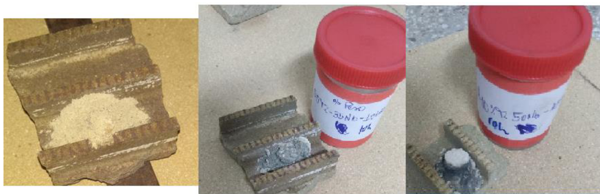
Figura 50: Produção das amostras do sistema titânio-nióbio (TiNb) compactadas a 40kN sinterizadas a 1200°C por 30min.
