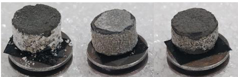
Figura 56: Amostras sinterizadas do sistema titânio-nióbio (TiNb) compactadas a 60kN e sinterizadas a 1200°C por 10min com atmosfera de argônio a 10L/min.
