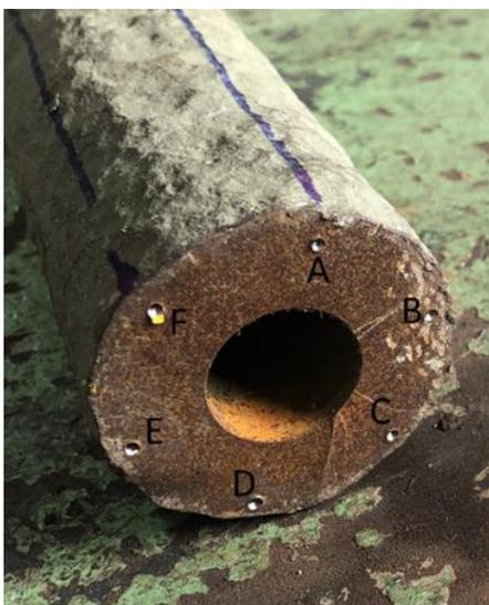
**Figura 39** - Medição de espessura inicial para tubo interno de CP2.
