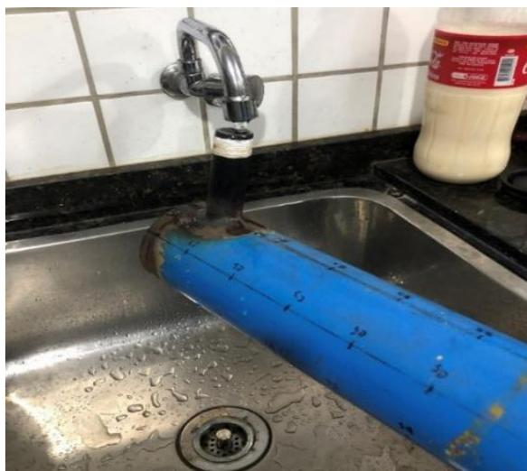
Com o corpo de prova pronto para o ensaio, CP1 foi nivelado sobre a bancada, então posicionou-se o transdutor de 5 MHz na posição da geratriz G e perpendicular à superfície do tubo externo, na sequência movimentou-se o transdutor até a marcação da posição do primeiro rebaixo, captando assim o sinal de ultrassom na forma *A-scan*. O procedimento foi repetido ao longo dos 10 rebaixos de CP1, resultando em 10 sinais que foram salvos em *pen drive*.
