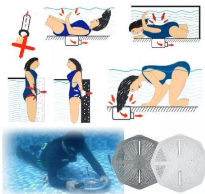
Figura 24: Funcionamento do dreno anti-aprisionamento
