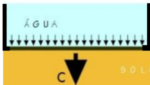
Figura 5: Modelo de forças exercida pela piscina apoiada
