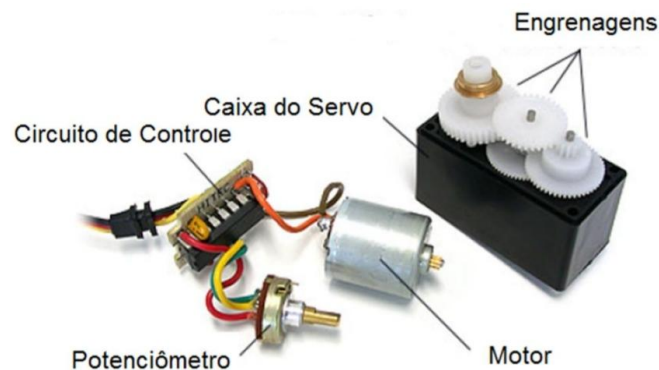
Figura 5- Componentes internos do Servo Motor
